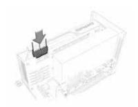
4 外部電源が必要なグラフィックスカードを取り付ける場合には、 SAPPHIRE GearBoxの外部電源ケーブルを利用し、左図の ように正しくかつ確実に接続してください。
