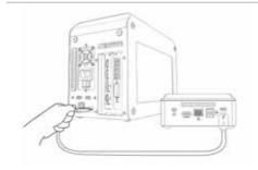
**1** Thunderbolt™ 3ケーブルをSAPPHIRE GearBox とお使いのシステムに接続します。
