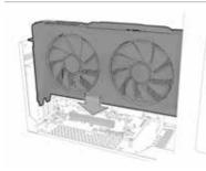
2 ラフィックスカードをSAPPHIRE GearBoxのPCI-Express x16パスに取り付けます。 グラフィックスカードの取扱に注意し、 左図のように正しく取り付けてください。
