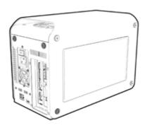
SAPPHIRE GearBoxのトップカバーを閉じ、1で外した4本の ネジを確実に締めます。これでSAPPHIRE GearBoxをお使 いのシステムに接続する準備が整いました。
